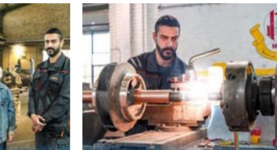
صيانة تكنا من إعادة تأهيل أهم جزء في مضخة الدفع باستخدام طريقة اللحام بالرش وهي عملية خام تستخدم فيها رش حبيبات مسحوق معدني بواسطة تسليط شعلة أوكسي - استيلينية حيث توجه نحو منطقة اللحام لمعالجة التآكل والسوفان في محاور التوربينات والمضخات. وأضاف ان هذه الطريقة تم إدخالها للمعمل لصيانة مختلف المعدات الدوارة بعد إجراء التحديشات عليها من قبل
